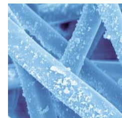
Separet Filtermedium staubbeladen, 200-fach vergrößert
