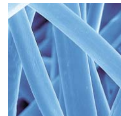
Separet Filtermedium unbeladen, 200-fach vergrößert
