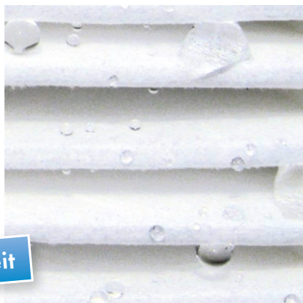
Das NanoPleat Filtermaterial bewährt im Wasser-Langzeittest.
