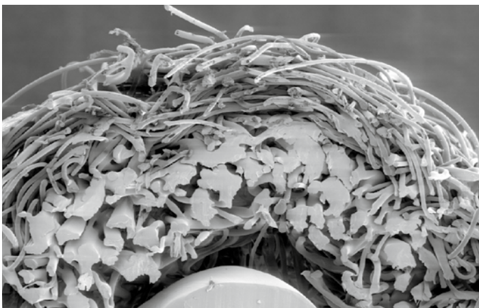
REM Aufnahme eines Hochleistungsfilters
